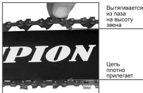
Рис. 5 Регулировка натяжения цепи
