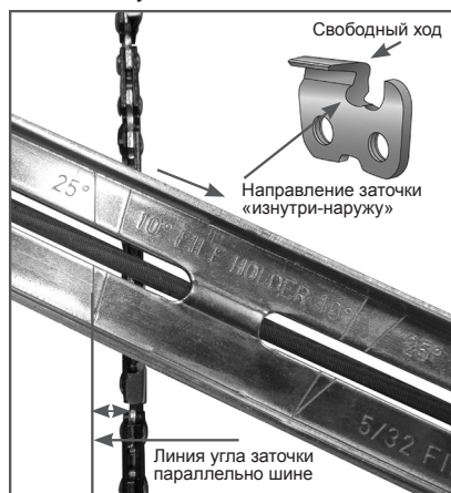
Рис. 28 Определение угла заточки
