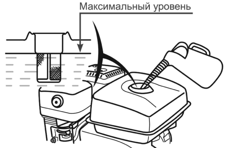
Рис. 28 Максимальный уровень топлива в топливном баке
