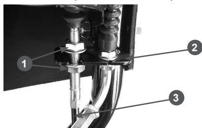
Рис. 11 Крепление оболочки троса включения хода
