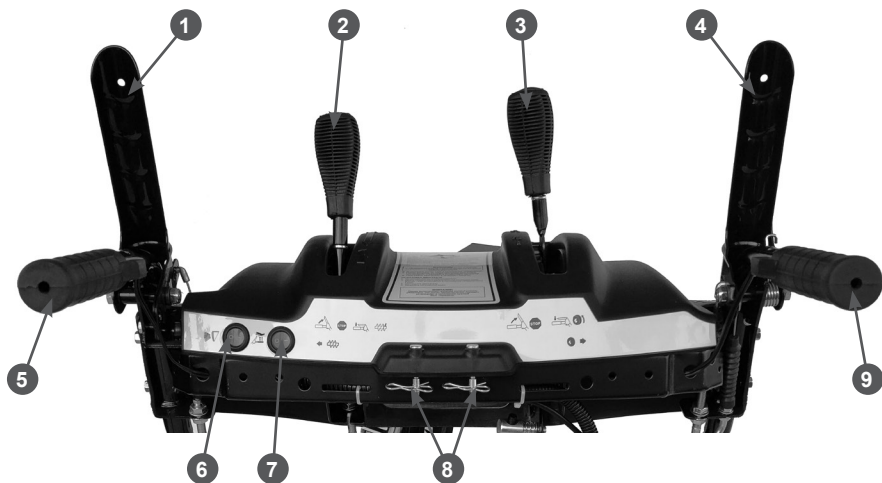
Рис. 2 Панель управления (вид со стороны оператора)
