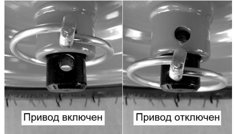
Рис. 35 Перестановка шплинта на левом колесе
